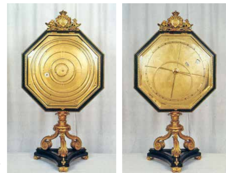
Ole Rømers Planetarium, der viser planeters bane over verdensrummet, blev i 1989 genskabt ud fra Ole Rømers tegninger efter en donation fra VELUX FONDEN. Planetariets forside til venstre viser de dengang seks kendte planeters gang om Solen: Merkur, Venus, Jorden, Mars, Jupiter og Saturn. På bagsiden til højre aflæses tidspunkterne for planeternes skiftende stilling i perioden 1580-1780.
